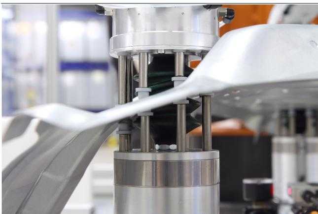
Ventosa Cup Balance SSCB durante movimentazione e bloccaggio automatizzato di un pezzo di lamiera
